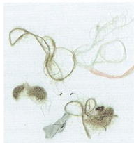
Zu den Fehlteilen, die mit der Windsichtung beseitigt werden, gehören Folienreste, Fäden, Haare, Papierfetzen, Bänder, Bastfäden, Nußhaut.
