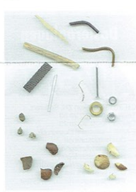
Zu den Fehlteilen, die mit dem Spezialsieb ausgeworfen werden, gehören kleine Steine, schmale Schalenreste, Holzsplitter, flache Metallteile, schmale Kunststoffteile, halbe Nüsse und Nußbruch.
